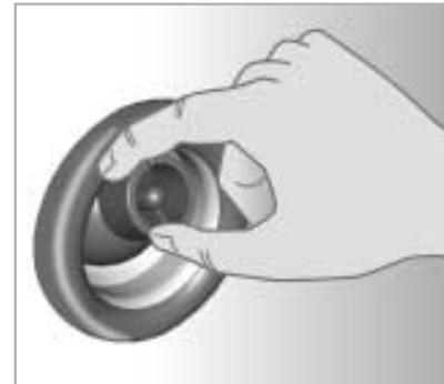
Необходимо уделять внимание на то, чтобы не сориентировать насадки гидромассажа в сторону всасывающей, поскольку это могло бы вызвать разжение установки и, следовательно, останов электронасоса.
