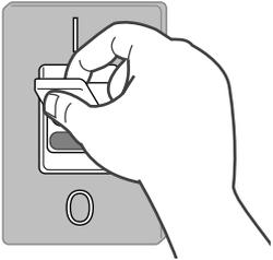
Postavite na "ON" glavni prekidač koji se postavlja prilikom montaže.
