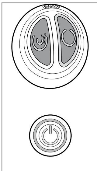
Gdy instalacja zakończy opróżnianie i będzie gotowa do przyjęcia polecenia nowej sauny, kolorowy pierścień przestanie migać zapali się światłem o niskiej intensywności.
