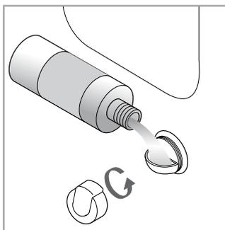
**TYLKO W TYM MOMENCIE NALEŻY WLAĆ PŁYN ODWAPNIAJĄCY DO ODPOWIEDNIEGO OTWORU WLEWOWEGO.** Przygotować roztwór zgodnie z zaleceniami podanymi na opakowaniu płynu odwapniającego.
