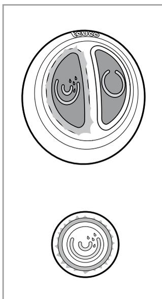
Если во время работы сауны пар из распределителя не выходит и периодически вспыхивает окрашенный сектор кнопки ”☺” на панели управления, проверить наличие воды в гидравлической системе.
