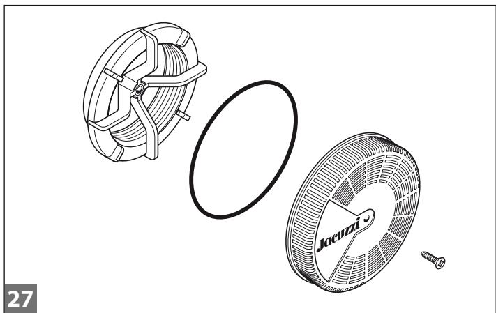
■ (扳手 27) Dévissez la vis et le couvercle (attention à ne pas décrocher le ressort du clapet interne).
