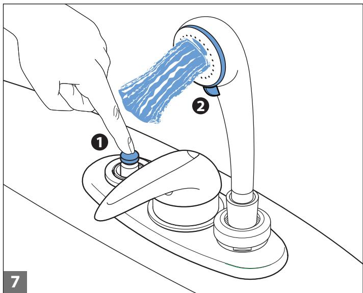
■ (☞ 8) Para sacar la ducha de su soporte, presionar la tuerca anular hacia abajo (1) y rotarla aproximadamente 45° (2). Al finalizar su uso, colocar la ducha en su soporte, presionar la tuerca anular y rotarla aproximadamente 45° hasta que salte hacia arriba (cierre de la junta en el flexible).
