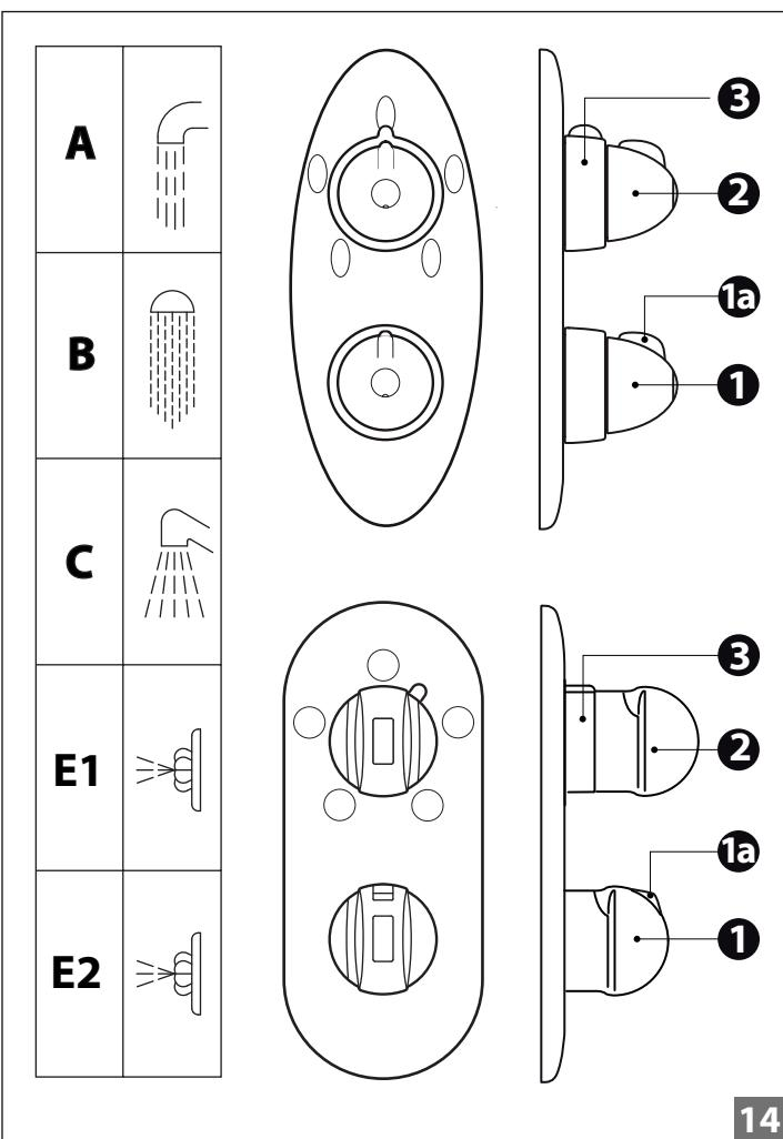
■ (☞14) In diesen Modellen ist die Einstellung der Wassertemperatur vereinfacht, da die Werte in Celsius (°C) angegeben und direkt auf der Nutmutter des thermostatischen Mischers angezeigt sind.
