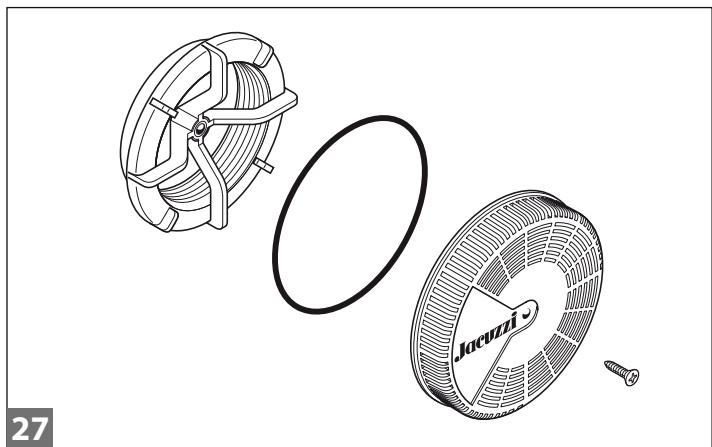
■ (☞ 27) Entfernen Sie die Schraube und den Deckel (achten Sie darauf, dass die Feder der internen Klappe nicht aushakt).
