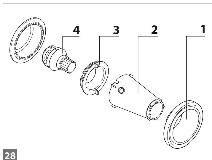
■ (☞ 28) Entfernen Sie mit dem Druck eines breiten Schraubenziehers unter dem Rand die Flanschabdeckung (1).
