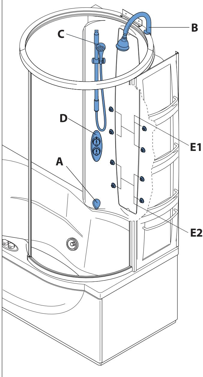
■ (A) Кран подачи воды в ванну; расположен в самой нижней части панели.
