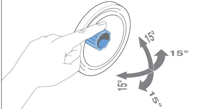
■ Stellen Sie sicher, dass die Wassermassagenöffnungen auf die Punkte des Körpers gerichtet sind, die Sie zu massieren wünschen (☞ 18); man erhält die Richtung durch einfaches Bewegen der Düse. *Die eventuell drehenden Strahlen können nicht ausgerichtet werden.*
