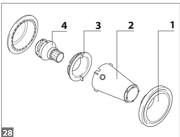
■ (扳手 28) Retirez le couvre-bride (1), en faisant levier sous le bord à l'aide d'un tournevis à lame large.
