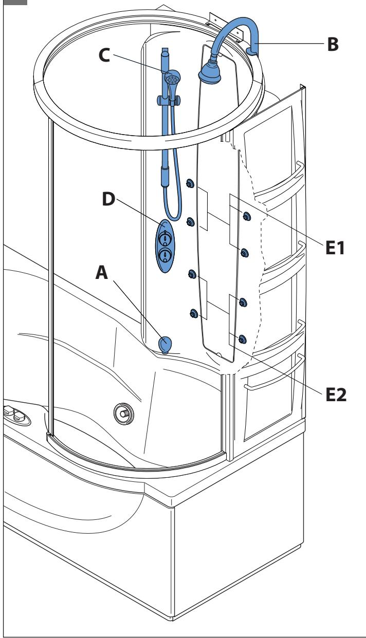
■ (A) **Einlauf in die Wanne**, liegt am Sockel der ausgestatteten Säule und ist zum Füllen der Wanne gedacht.
