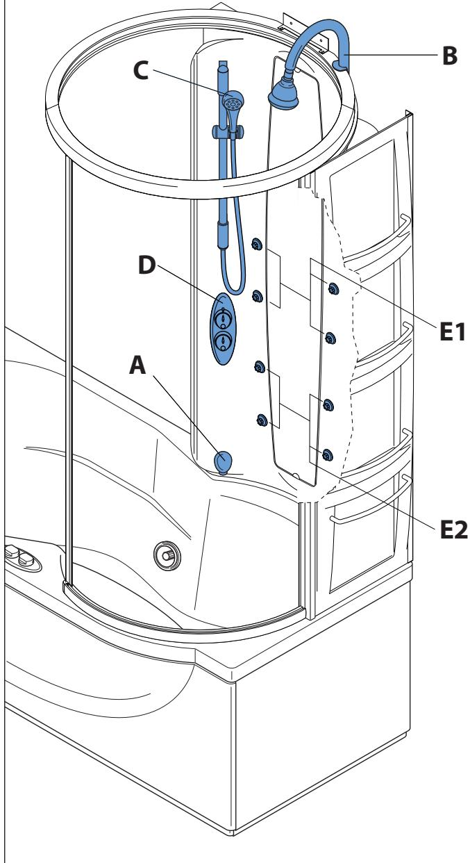
■ (A) Distributeur en baignoire situé à la base de la colonne technique et dédié au remplissage de la baignoire.
