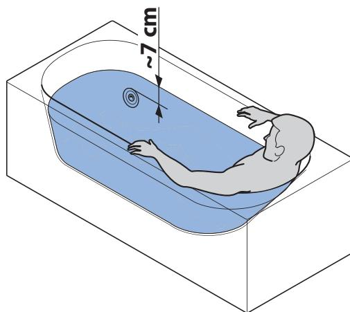
La vasca è dotata di un sensore elettronico che impedisce alla pompa di avviarsi se il livello d'acqua è inferiore a quello previsto; per cui, se premendo il pulsante (B) la pompa non parte e sentirete un "bip" prolungato, occorrerà aggiungere acqua e ripremere il pulsante.
