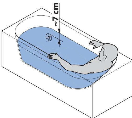
La bañera cuenta con un sensor electrónico que impide que la bomba se ponga en funcionamiento si el nivel del agua es inferior al previsto; por lo tanto, si se presiona el pulsador (B) y la bomba no arranca, se oirá un "bip" prolongado. En este caso agregar agua y volver a presionar el pulsador.
