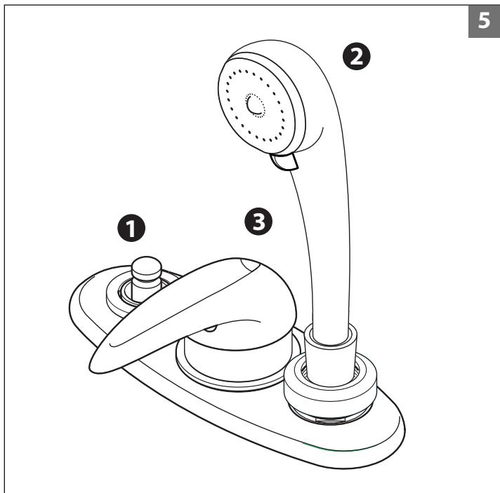
■ Zum Füllen der Wanne heben Sie den Hebel des Einhebelmixers (3); um die gewünschte Temperatur einzustellen, den Hebel des Mischers drehen.
