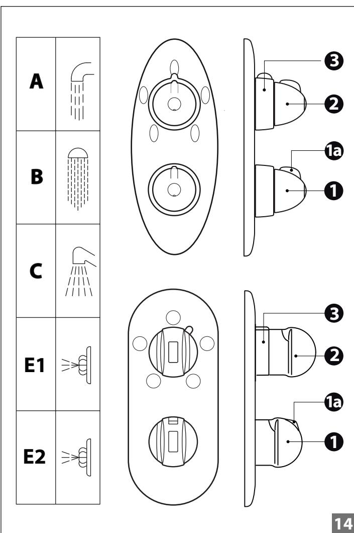
■ (☞ 14) En estos modelos la regulación de la temperatura del agua es más simple dado que los valores, en grados centígrados (°C), se indican directamente en la tuerca anular del mezclador termostático.
