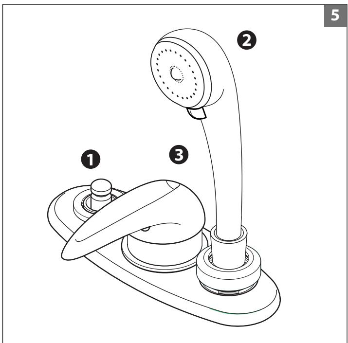
■ Per riempire la vasca, alzate la leva del miscelatore monocomando (3); per regolare la temperatura desiderata, ruotate la leva del miscelatore.
