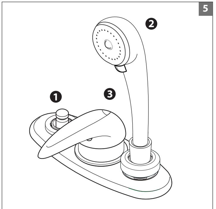
■ Чтобы открыть кран, поднимите рычаг смесителя (3) вверх; чтобы смешать горячую и холодную воду в нужном соотношении, поворачивайте рычаг вправо или влево.
