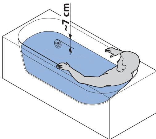
Ванна оборудована специальным датчиком, который препятствует включению гидромассажа, если уровень воды в ванне недостаточен. Если вы нажимаете кнопку режима гидромассажа, но при этом насос не включается, а вместо этого раздается предупредительный сигнал, это означает, что уровень воды нужно повысить, после чего снова нажать кнопку пуска.
