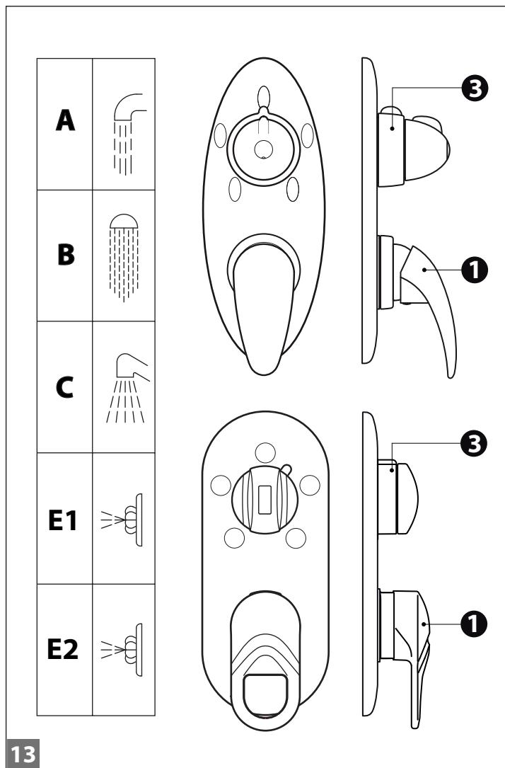
**⚠** Prima di utilizzare qualsiasi funzione vi consigliamo di regolare la temperatura dell'acqua sul valore desiderato, utilizzando il getto dell'erogatore in vasca:
