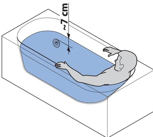
Die Wanne ist mit einem elektronischen Fühler ausgestattet, der verhindert, dass die Pumpe startet wenn der Wasserstand unterhalb des vorgesehenen ist; daher startet die Pumpe bei Drücken des Knopfes (B) nicht und Sie werden einen verlängerten „Piepton“ hören, es wird notwendig sein Wasser hinzuzufügen und den Knopferneut zu drücken.
