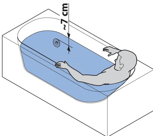
La baignoire est équipée d'un capteur électronique qui empêche à la pompe de démarrer si le niveau de l'eau est inférieur à celui prévu ; aussi, si après avoir actionné le bouton (B), la pompe ne démarre pas et un bip long retentit, cela signifie qu'il faut ajouter de l'eau et rappuyer sur le bouton.
