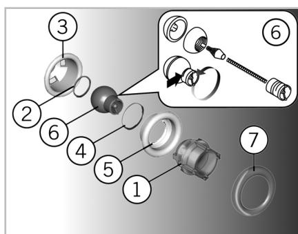
Специальным ключом (1) демонтируйте патрубок и разделите его на части. Можно еще больше разобрать шарик (6), для этого отвинтите насадку и нажмите стопорный язычок в указанной на рисунке стрелкой точке. Для очистки используйте антинакипин, после чего ополосните патрубок водой.
