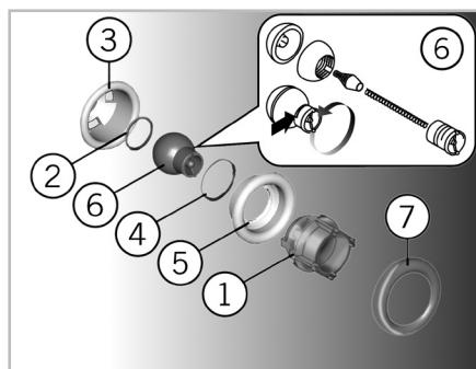
Koristeći zasebni ključ (1) rasklopite otvor i izvucite sve sastavne dijelove. Kuglica (6) može se dalje rasklapati odvijanjem štrcaljke i pritiskanjem jezička za blokiranje na točki koja je naznačena strelicom.
