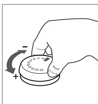
Mješalica zraka omogućuje reguliranje željene količine zraka/vode tijekom rada.
