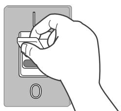
**Postavite** na "ON" glavni prekidač koji se montira u fazi instaliranja.
