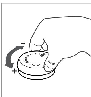
Устройство смешения воды с воздухом позволяет регулировать нужное количество смеси воздух-вода во время работы системы. Усиление и уменьшение потока воздуха регулируется ручкой.
