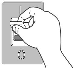
Ustawić na "ON" wyłącznik główny zamontowany w fazie instalacji.
