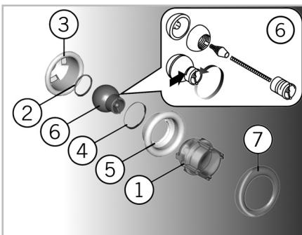
Przy pomocy odpowiedniego klucza (1) zdemontować otwór, zdejmując wszystkie jego elementy. Kulę (6) można dalej rozmontować, odkręcając dyszę i wciskając wpust blokady w miejscu wskazanym strzałką. Do czyszczenia używać odkamieniacza, spłukując wodą.
