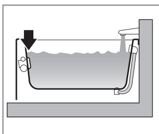
Заполните ванну водой так, чтобы она покрыла форсунки.
