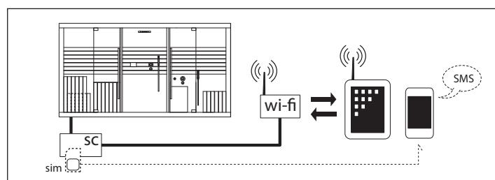
En cualquier caso, se debe preparar una toma Ethernet (RJ-45), como se indica en la pos. 8, a la que conectar el cable (longitud: ~ 5 m) proveniente del sistema de control a distancia.
