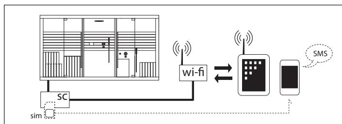
Dans tous les cas, il faut prévoir une prise Ethernet (RJ-45), comme indiqué à la pos. 8, à laquelle raccorder le câble (longueur : ~ 5 m) provenant du système de contrôle à distance.
