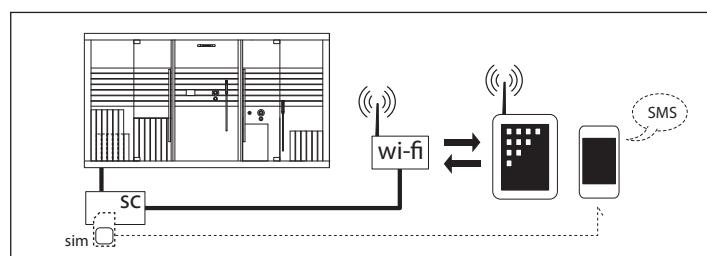
In jedem Fall muss eine Ethernet Buchse (RJ-45) vorhanden sein, wie in Pos. 8 angegeben, an die das von der Fernbedienung kommende Kabel (Länge: ~ 5 m) angeschlossen wird.
