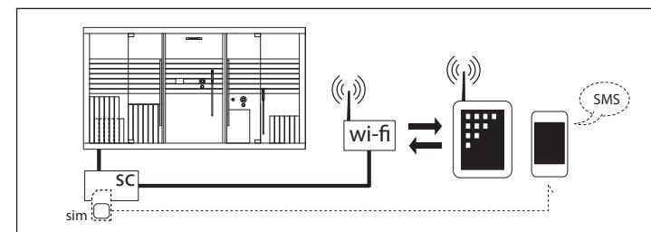
В любом случае, необходимо предусмотреть розетку Ethernet (RJ-45), в соответствии с поз. **8**, к которой подсоединить провод (длиной: ~ 5 м), выходящий из системы дистанционного управления.
